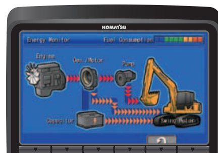
Skjerm bilde for Hybrid-energistyring
