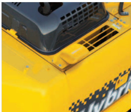
Sidemontert kamera, høyre side (ekstra utstyr)
