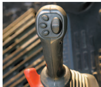
Gravespaker med brytere for proporsjonalstyring av redskaper som standard
