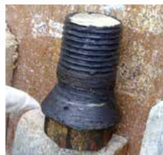
Bildet viser korrekt påføring av fett på gjenger og kon før montering.
