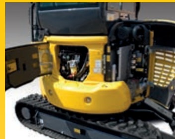
Deksler bak på maskinen for rask motorsjekk, enkle kontroller, rensing av kjølere og enkel tilgang til batteriet
