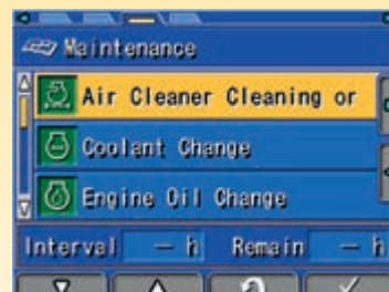
Multifunksjonsskjermen gir maskinføreren vedlikeholds- og serviceinformasjon
