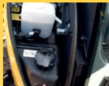
Praktisk og sikker drivstoff- og oljepåfylling under frontdekselet
