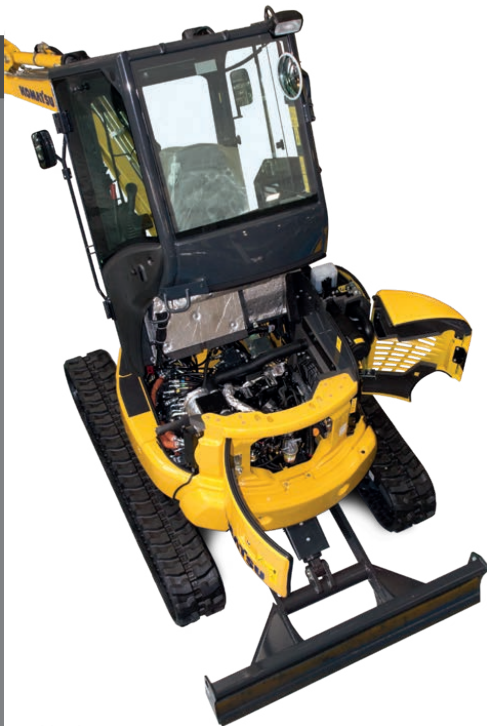
Deksler bak på maskinen for rask motorsjekk, enkle kontroller, rensing av kjølere og enkel tilgang til batteriet
