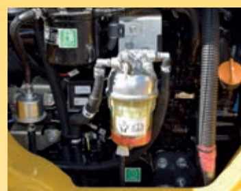
Stort drivstoffilter og forfilter med vannutskiller beskytter motoren
