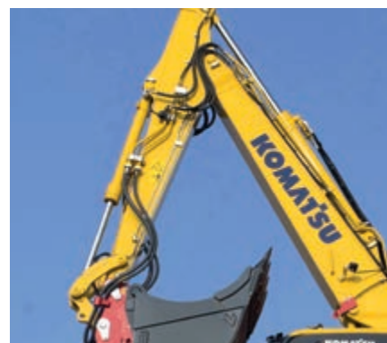
Nytt HCU-rørapplegg med enhetlig design for alle stikkellengder
