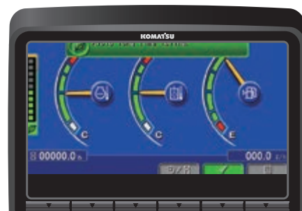
Eco-måler, eco-tips og justerbar auto stopp funksjon for ytterligere reduksjon i dieselforbruket
