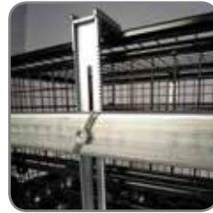
Holderne kan velges med eller uten beslag (ekstra utstyr). Beslag anbefales når det skal vendes mer enn 60°.
