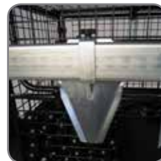
Justerbare holdere: Alt etter lastens stabilitet og utførelse så kan det som ekstra utstyr leveres sidestøtteplater.
