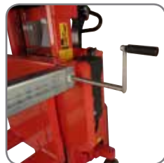
Justerbare holdere: Bredden justeres manuelt til ønsket bredde på lasten mellom 800 mm og 1200 mm.
