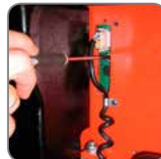
Enkel justering av vippegrader og rotasjonshastighet.
