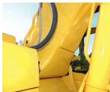
Støpt bomfot og plater i bommen fremstilt i ett stykke
