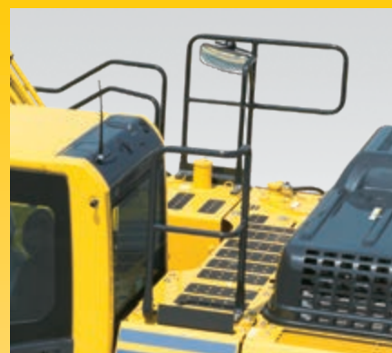
Rekkverk og sklisikre plater
