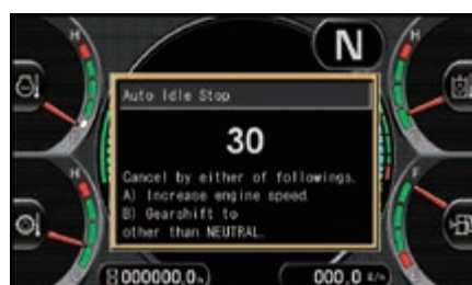
Justerbar tomgangsautomatikk stopper automatisk motoren etter en bestemt innstilt tidsperiode
