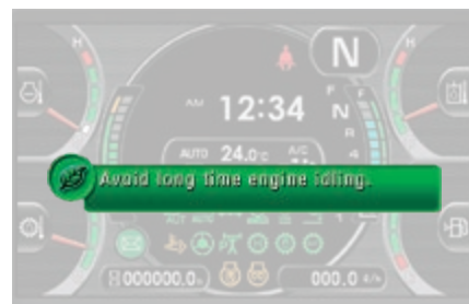
Eco Guidance støtter energisparing i sanntid (f.eks. ved å unngå at motoren går lenge på tomgang)
