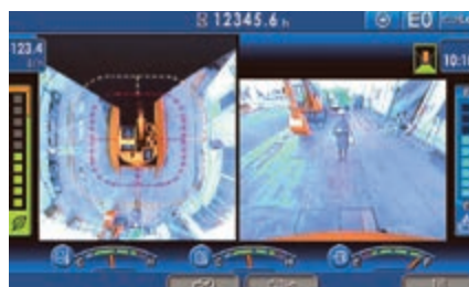
Med KomVision er ulike kameravisningsmuligheter tilgjengelig mens du har konstant "fugleperspektiv" sett over maskinen
