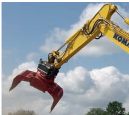
To hydraulikkretser for tilkobling av en rekke ulike arbeidsredskaper (ekstraustyr; en hydraulikkrets er standard)
