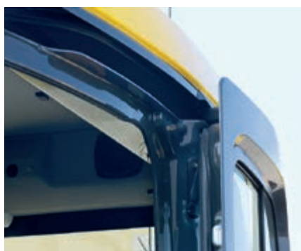
Buet skyvedør gjør det enkelt å komme inn og ut, og reduserer faren for skader ved arbeid langs vei.
