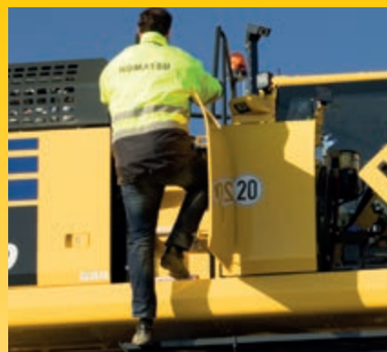
Rett stige for servicearbeid; rekkverk og glidebeskyttelse
