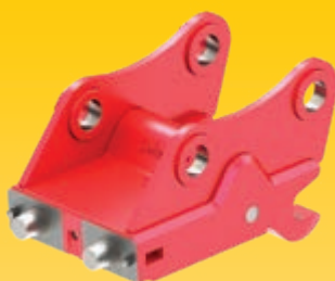
Mekanisk hurtigkobling MS10 Slitesterk og pålitelig også under tungt arbeid. Låses ved å dreie en pipenøkkel, sikkerhetslåst over dødpunktet.
