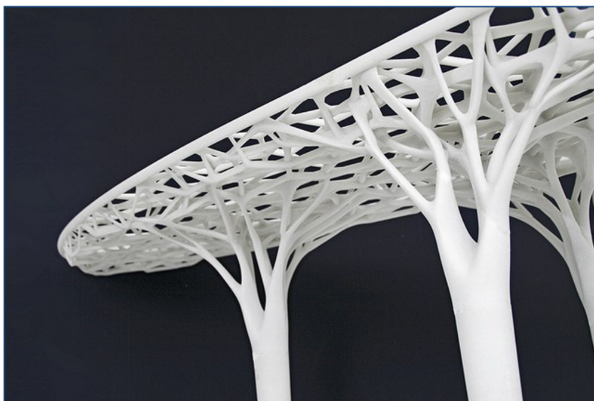
Figur 4: 3D-printere kan bygge geometrisk svært komplekse modeller. Bildet viser utsnitt av "The Trabecula Bench". Benken er 36 cm. høy og 180 cm. lang, og strukturen i benken er basert på strukturen i et fugleben.
