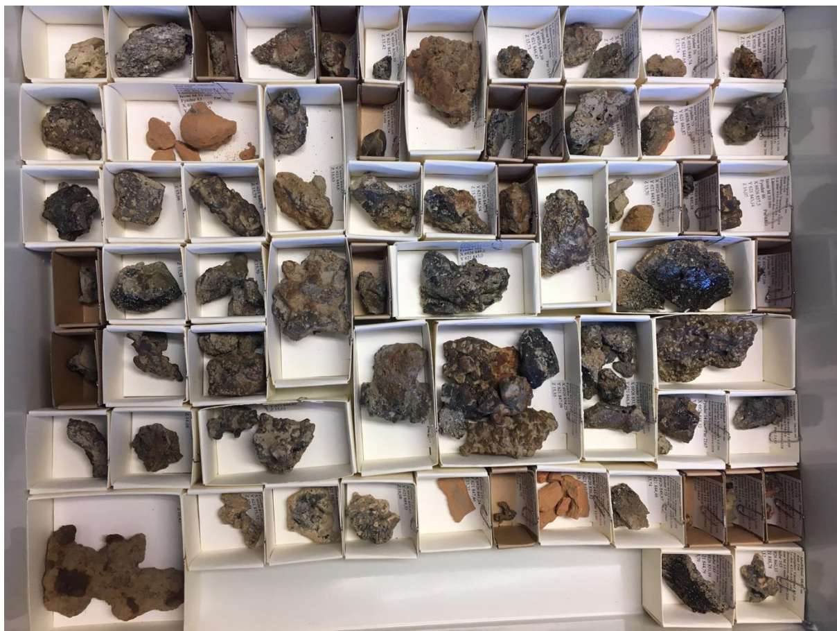
Figur 36. Back med fynd från Raä 104:3. Fynden består till övervägande delen av smidesslagg, hårdfodring och sintrad lera.
