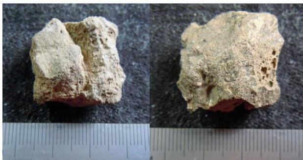
Fig.1. Skärva av sluten degel – tv innersida med rest av innerskål och till höger förglasad utsida (Västra huset F372).
