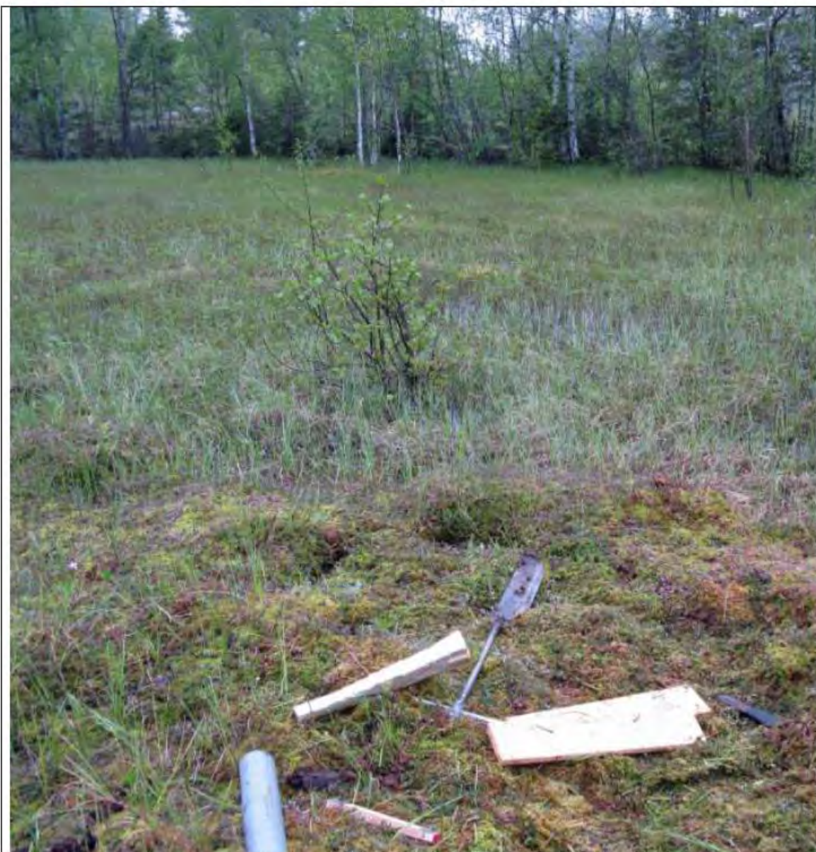
Figur 2: Provtagningsplatsen: Solberg. På bilden visas den utrustning som användes vid provtagningen, en "Rysk torvborr". Foto: Jan-Erik Wallin
