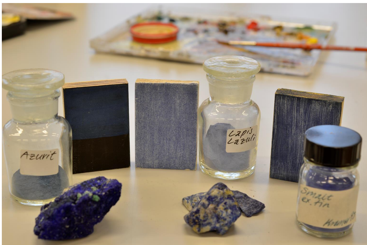
Från vänster: pigmentet azurit, mineralet azurit, azurit uppmålad i limfärg på svart undermålning, lapis lazuli uppmålat i linolja, mineralet lapis lazuli och pigmentet lapis lazuli, smalt uppmålat i linolja och pigmentet smalt.
