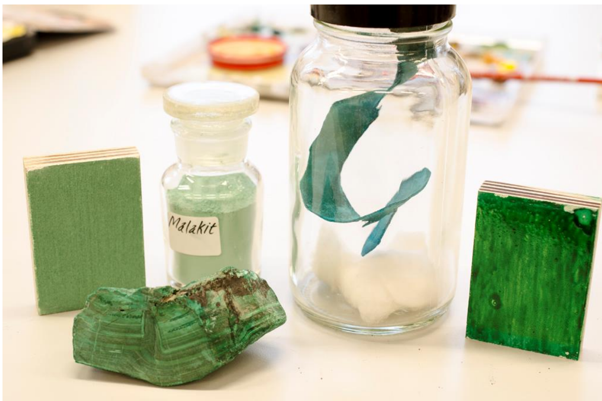
Från vänster: malakit uppmålat i linolja, mineralet malakit och pigmentet malakit, en kopparplåt i glasflaska med en bomullstuss med ättika orsakar korrosionen kopparacetat, kopparacetat i harts (kopparresinat) uppmålat.
