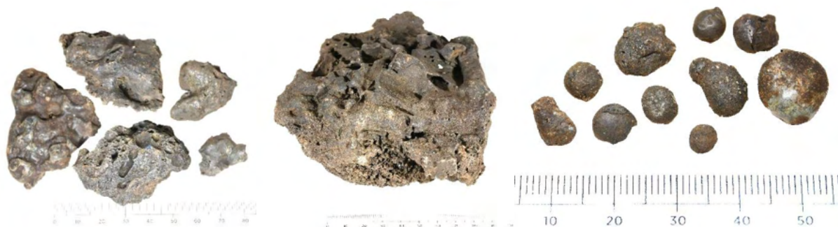
Figur 99, 100 och 101. Slagg, bottenkälla och kulslagg (alla från Fnr 1983) från schakt 2.
