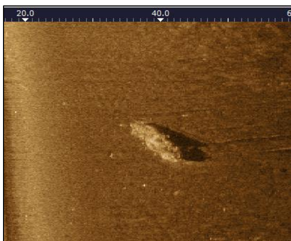
Figur 8. Sonarbild på indikation B089 som med stor sannolikhet är vraket efter den förolyckade ångslupen "Kungsgården".
