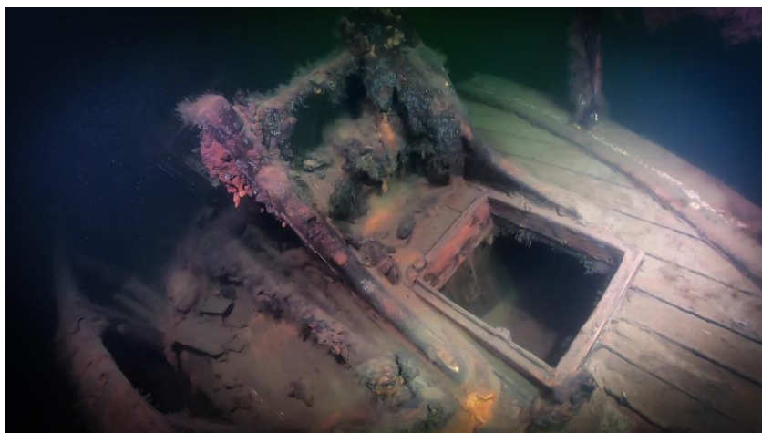
Figur 9. Vraket efter vad som förmodligen är ångslupen Kungsgården vilar med styrbord slagsida på 16 meters djup. På bilden syns ankarspelet och en däckslucka där ankartåget förmodligen förvarades. Foto: Jens Lindström/ NMG.
